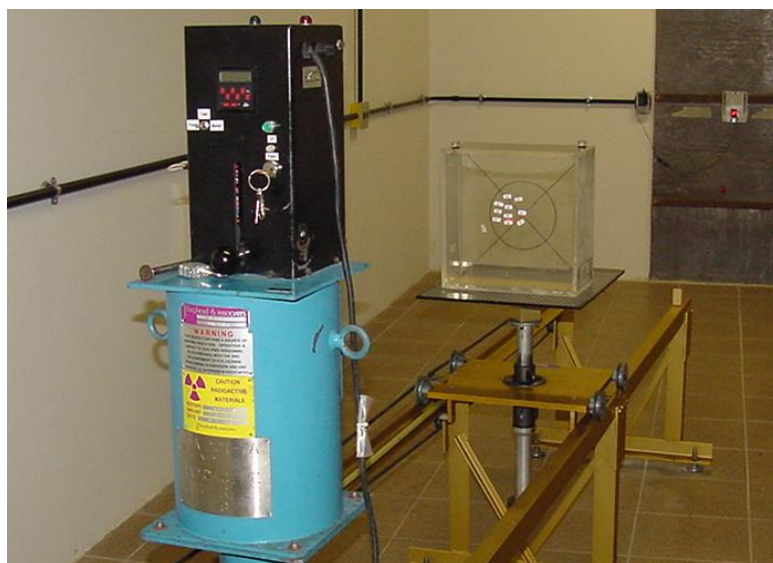
Figura 22. Arranjo para irradiação dos TLD no simulador slab .
