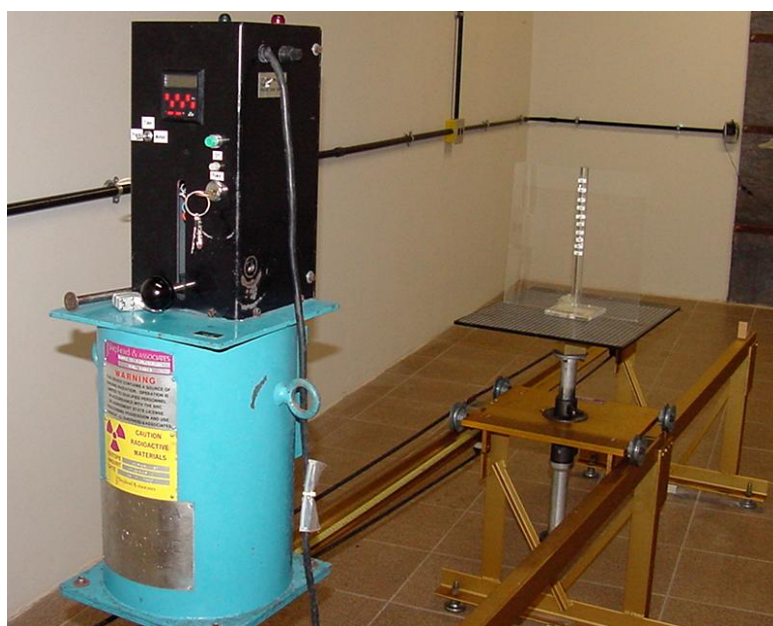
Figura 23. Arranjo para irradiação dos TLD no simulador rod .
