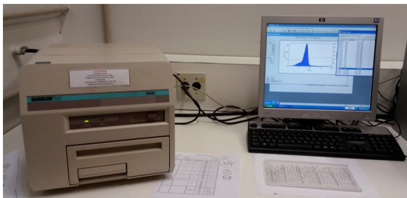
Figura 18. Leitora manual Harshaw modelo 3500.
