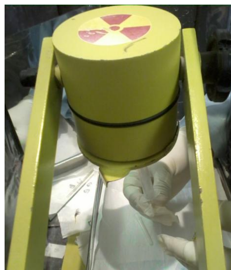
Figura 13. TMN preparando a atividade de ^{18}\text{F} , utilizando, para isso, um dispositivo fracionador de dose do tipo orbital.
