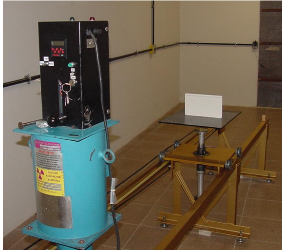
Figura 20. Arranjo experimental da irradiação dos TLD na fonte de ^{137}\text{Cs} do LABIR.
