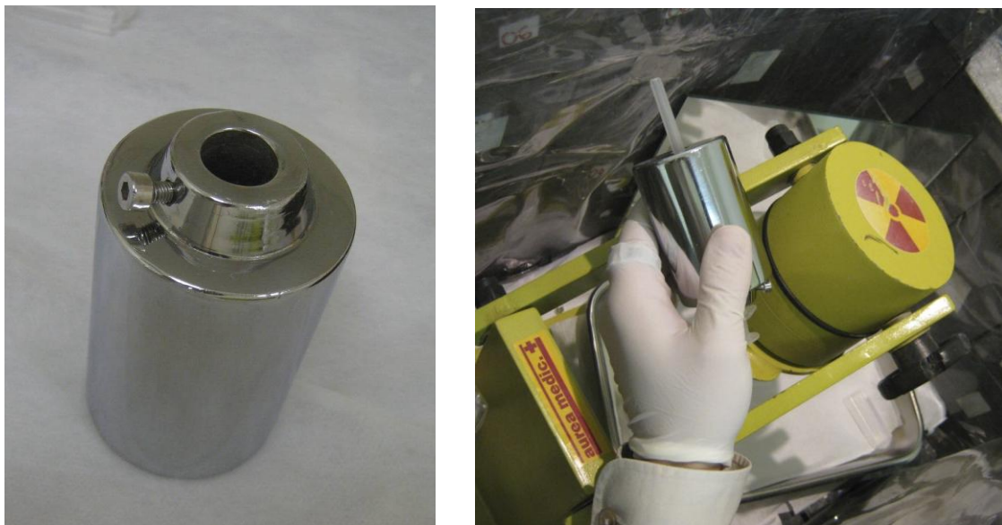
Figura 15. Protetor de seringa com blindagem de 6 mm de tungstênio para procedimentos de PET.
