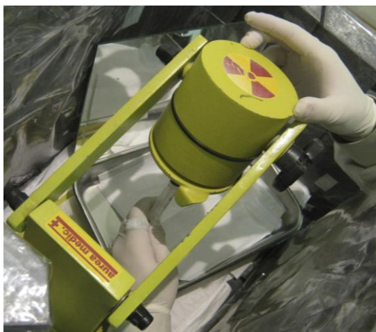
Figura 13. TMN preparando a atividade de ^{18}\text{F} , utilizando, para isso, um dispositivo fracionador de dose do tipo orbital.
