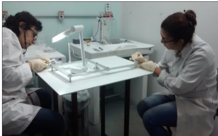
Figura 4.1. Contaminação artificial dos filtros de ar com auxílio de pantógrafo.
