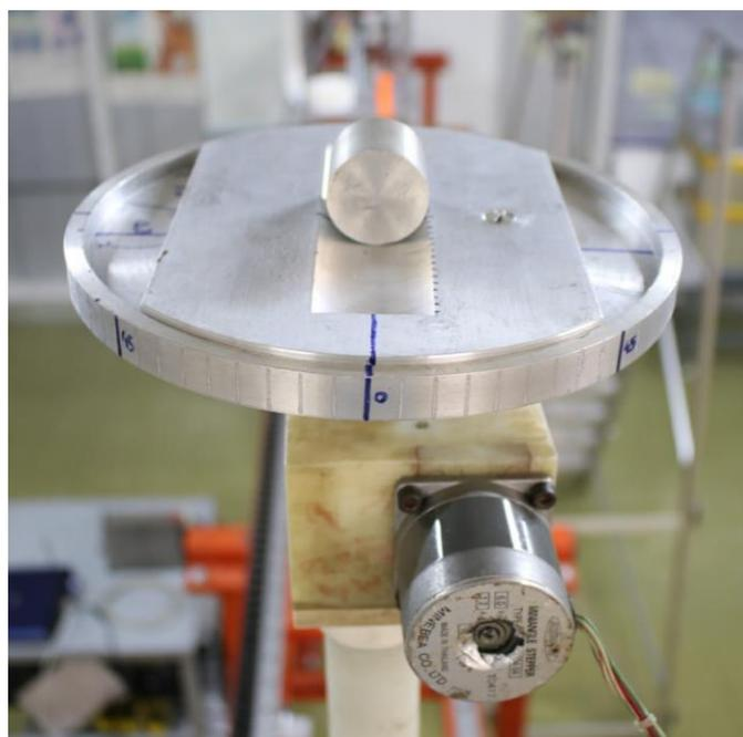
Figura 2. Sistema mecânico de rotação de fontes
