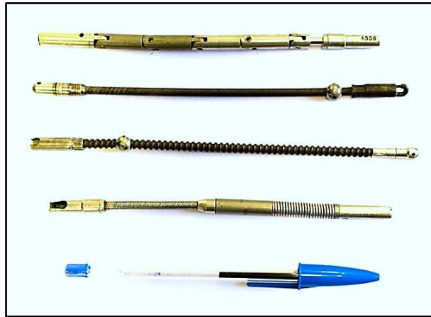
Figura 7: Porta fontes utilizados em gamagrafia. Fonte: Laboratório de Indústria do IRD, 2017.
