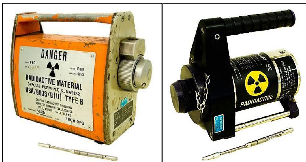
Figura 6-A: Irradiador para gamagrafia TECH OPS. Fonte: Laboratório de Indústria IRD, 2017.
