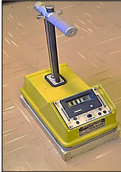
Figura 8: Medidor nuclear de densidade de solo portátil. Fonte: Laboratório de Indústria do IRD, 2017.
