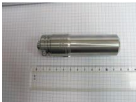
Figura 4: Fonte de Césio-137 usada na perfilagem de poço de petróleo Fonte: IAEA(2007)
