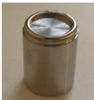
Figura 6: Fonte de ^{241}\text{Am-Be} usada na perfilagem de poço de petróleo Fonte: IAEA (2007)
