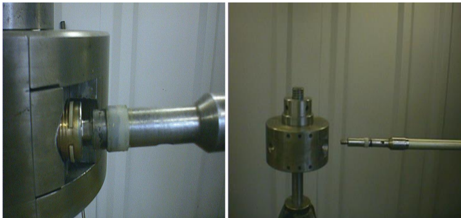
Figura 12: encaixe com um torque específico na colocação e remoção da fonte na sonda Fonte: (AIEA, 2017a)
