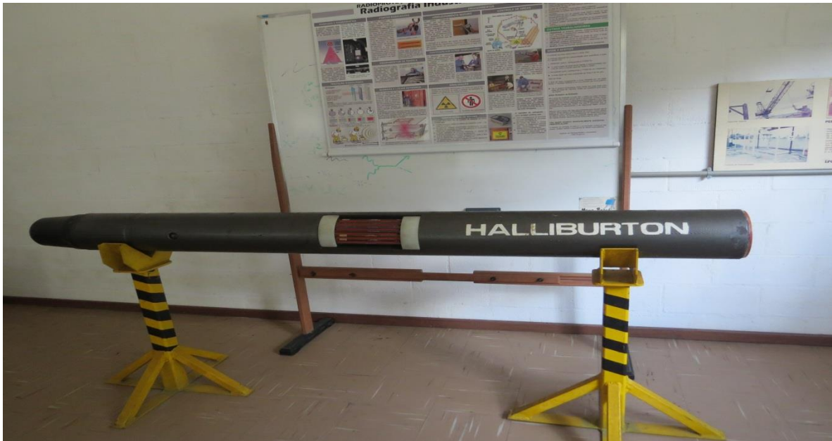
Figura 13: sonda usada na perfilagem de poço de petróleo Fonte: autora da pesquisa
