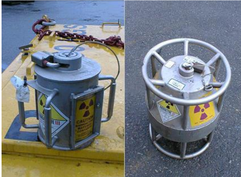
Figura 14: Tipos de blindagens de fontes radioativas à esquerda, blindagem utilizada para fonte de cézio 137 e à direita para fonte de amerício - berílio241
