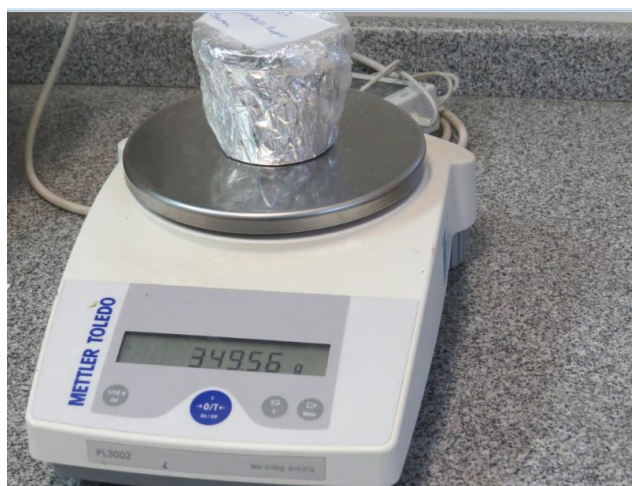
Figura 8. Pesando o pote com a amostra dentro
