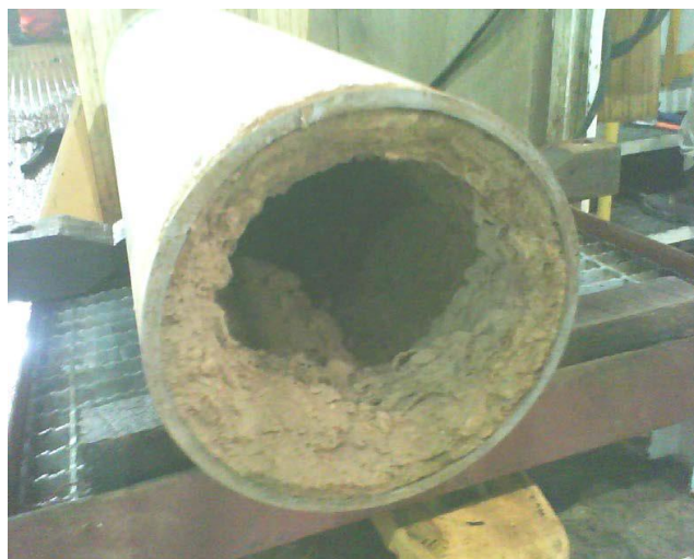
Figura 3: Incrustações depositadas num tubo de produção de petróleo e gás natural. Fonte: IAEA, Management of NORM Residues, 2013.
