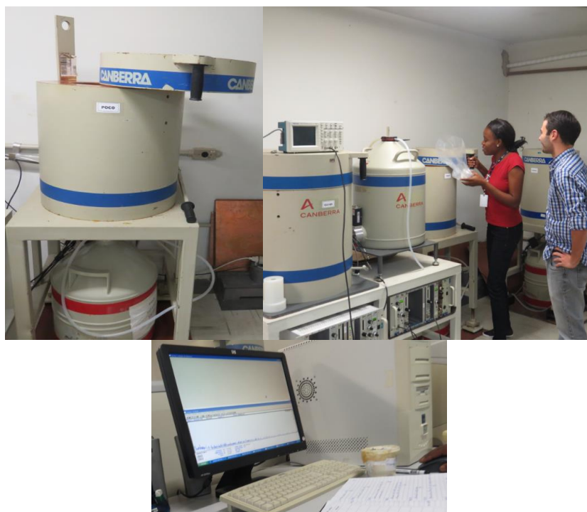
Figura 9. Contagem da amostra no detector HPGe-IRD/CNEN
