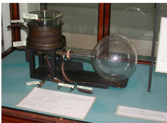
Figura 3: Câmara de Nevoeiro de Wilson. Fonte: Museu Laboratório Cavendish Cambridge.
