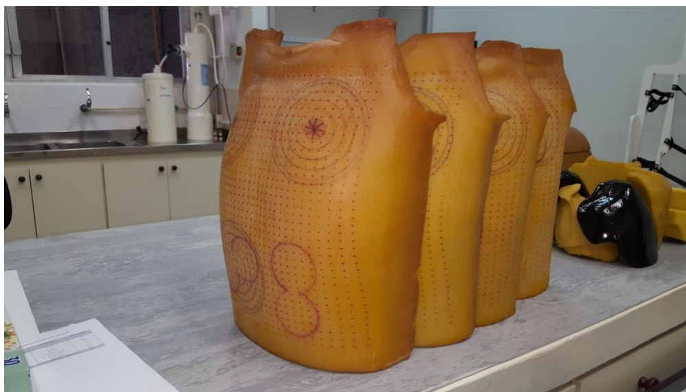
Figura 5 - Camadas frontais do simulador com diferentes espessuras
