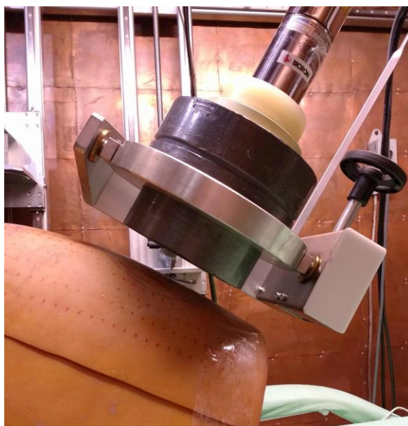
Figura 7 – Simulador de tórax posicionado sobre a cadeira em geometria padronizada
