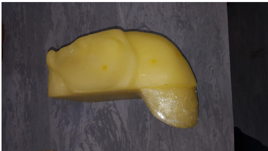
Figura 4 - Simulador de Fígado com ^{60}\text{Co} – visto de cima
