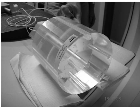
Figura 36. Imagem do posicionamento da câmara de ionização para obtenção do CTDI w (RENHA, 2007).
