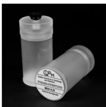
Figura 32. A) Simulador de PMMA (apenas para exatidão do número de TC da água). B) Simulador ACR, GAMMEX - modelo 464 para exatidão do número de TC de diversos materiais.
