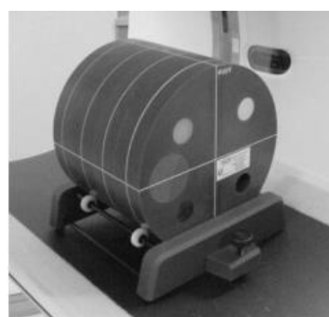
Figura 32. A) Simulador de PMMA (apenas para exatidão do número de TC da água). B) Simulador ACR, GAMMEX - modelo 464 para exatidão do número de TC de diversos materiais.
