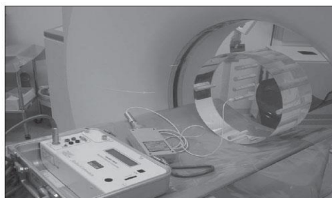
Figura 19. Sistema dosimétrico e simulador de corpo para determinação de CTDI_w .
