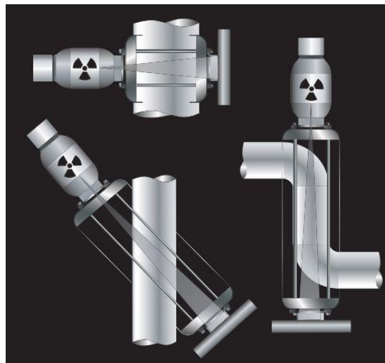
Figura 3 - Diferentes configurações de medidores fixos a tubos – (Canadian Nuclear Safety Commission, 2007).
