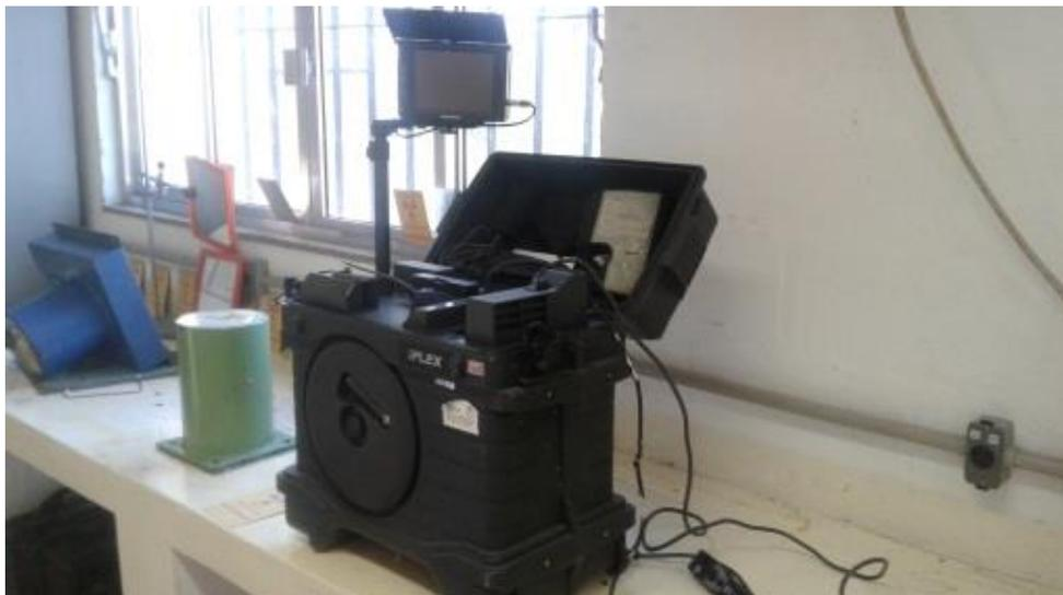
Figura 26: Endoscópio industrial
