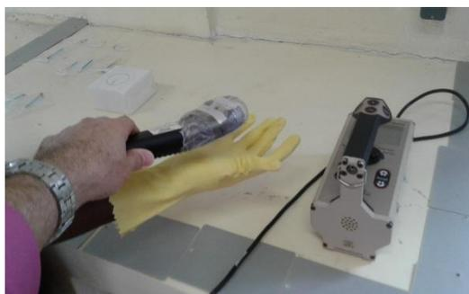
Figura 22: Verificação de contaminação nas luvas.
