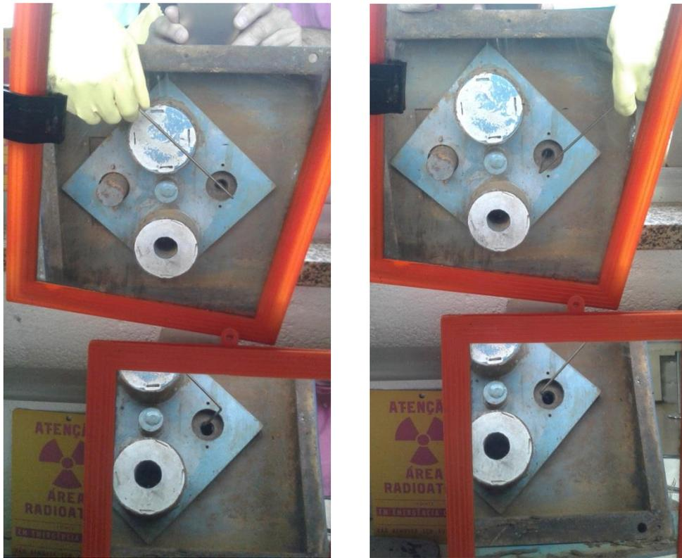
Figura 17: Esfregaço com haste no interior do orifício
