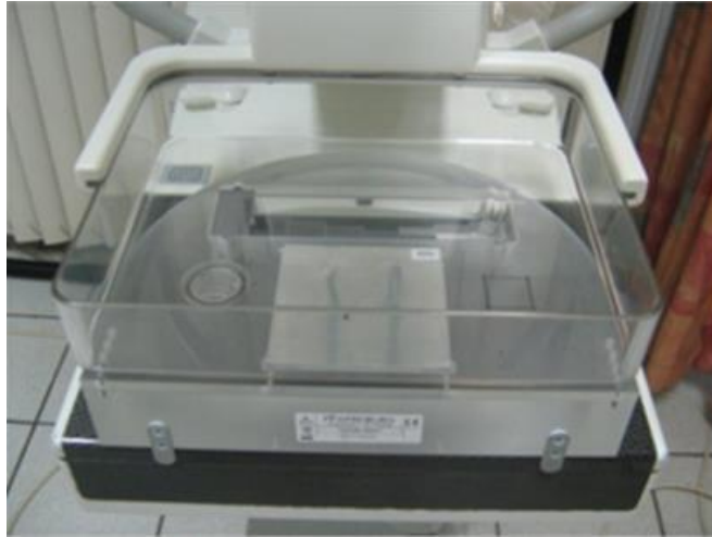
Figura 8: Fantoma posicionado para medições no mamógrafo.
