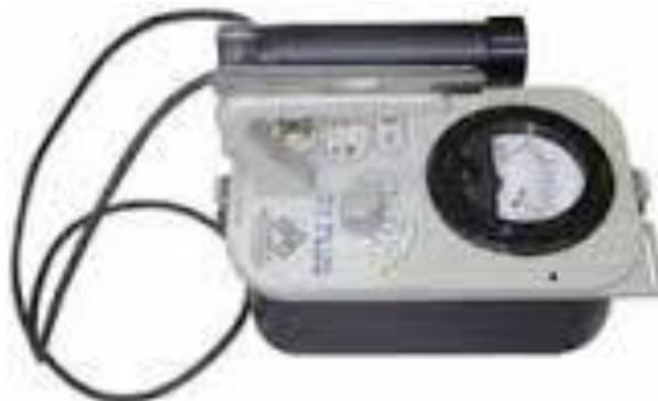
**Figura 4.1** Monitor do tipo Geiger-Müller utilizado para medição da taxa de exposição do paciente e dos pontos de referência do quarto terapêutico (Modelo G1-E do fabricante MRA).
