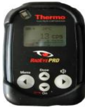
Fig. 7 - Cintilômetro portátil Rad Eye PRD, de alta sensibilidade, utilizado em atividades de triagem e localização de fontes emissoras de radiação gama [6].
