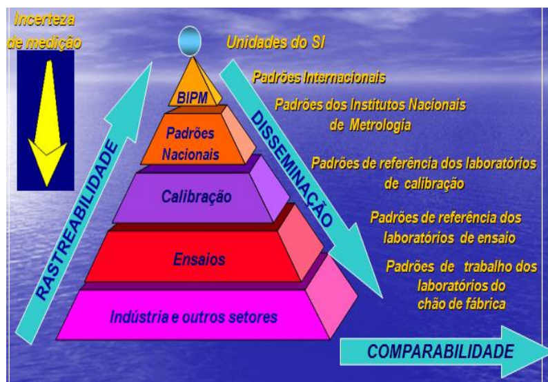
Fig. 3 – Representação da Hierarquia e rastreabilidade metrológica das medições realizadas pelos instrumentos dos usuários até aos padrões internacionais, para cada tipo de grandeza. Adaptado de [6,17].
