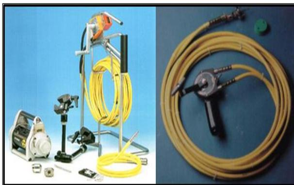
Figura 4: Equipamento para procedimento de Gamagrafia Industrial (Mussica, 2014)
