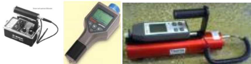
Figura 22: Equipamentos de monitoração de área
