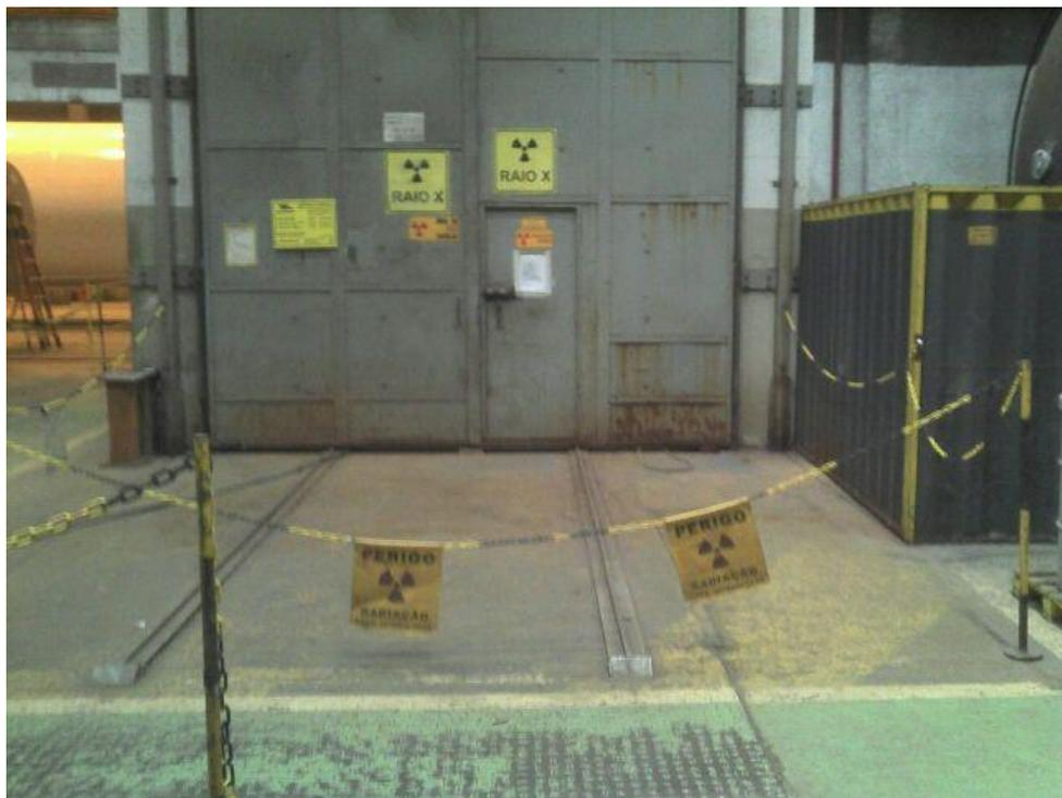
Figura 12 – Exemplo de isolamento de área.
