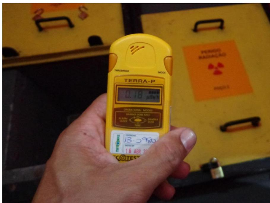
Figura 6 – Monitor de radiação portátil com alarme sonoro. (ECOTEST Terra-P MKS-05)
