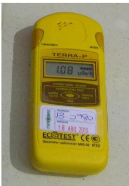
Figura 8 – Monitor de radiação portátil com selo de calibração.
