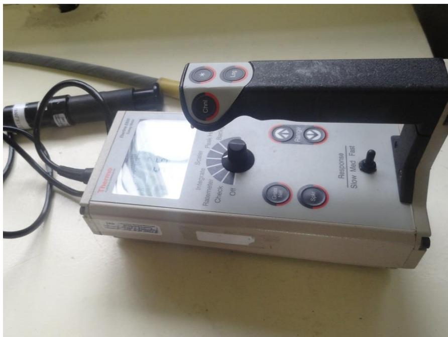
Figura 5 – Medidor de radiação do tipo Geiger Muller. (Thermo Eberline E600)
