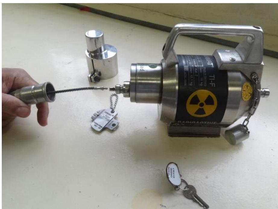
Figura 10 – Inspeção do irradiador e cabos com a utilização de gabarito de teste.
