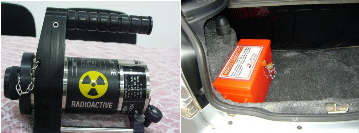
Figura V-16 – Irradiador GammaMat SE (semelhante ao roubado) e sua caixa de contenção (Dir)
