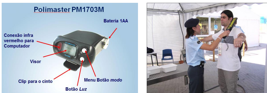
Figura 16: Diagrama Esquemático do Detector PoliMaster PM1703M
