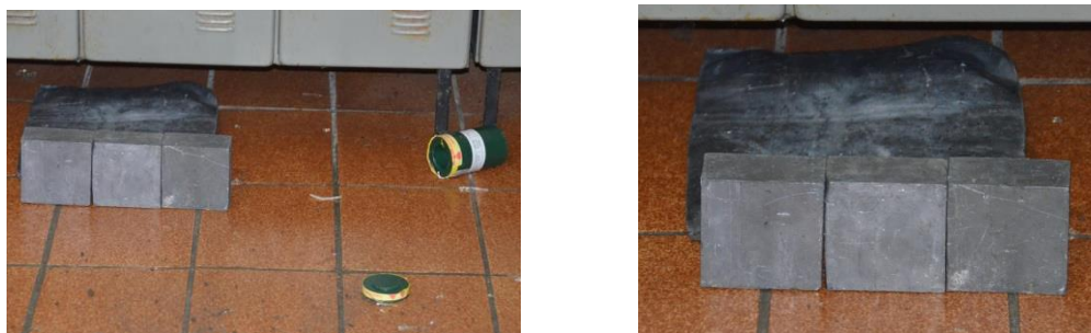
Figura 32: Blindagem da Fonte de Irídio-192
