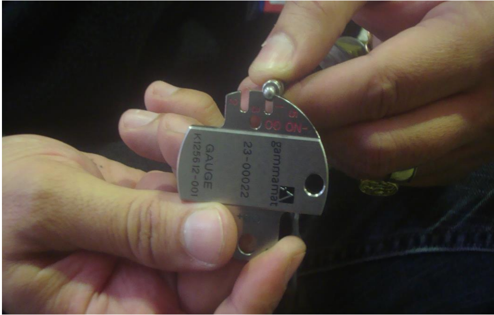
Figura X – Aferição do engate do irradiador com gabarito de teste
