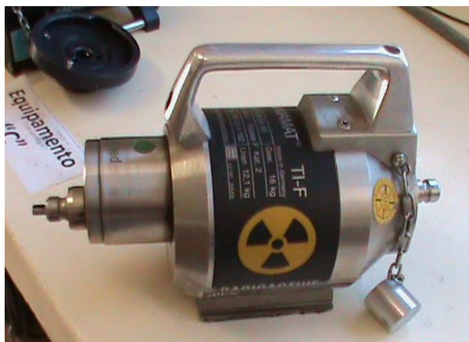
FIG. 2.5 Irradiador Gammamat TI-F.
