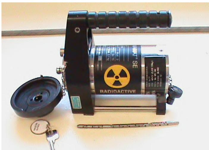
FIG. 2.4 Irradiador Gammamat  $^{75}\text{Se}$ .
