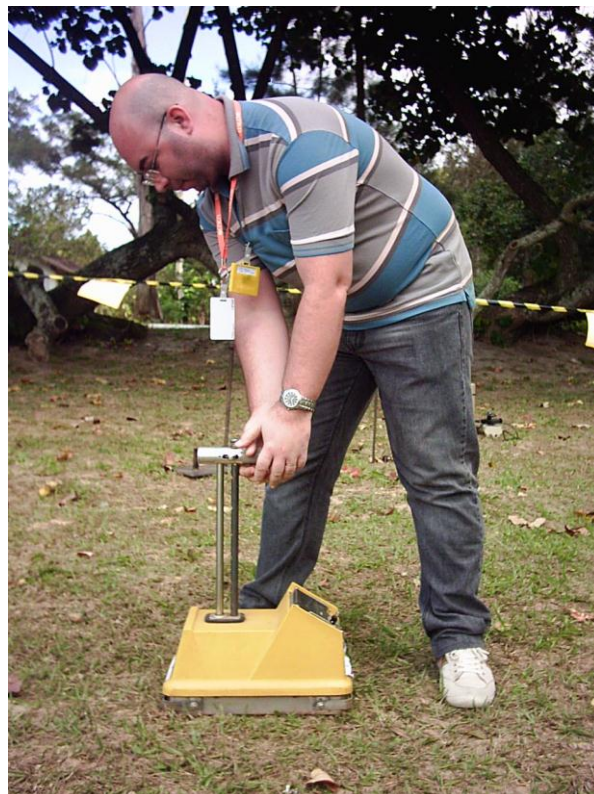
FIGURA 37 – Sonda no nível do solo para posição de retroespalhamento.
