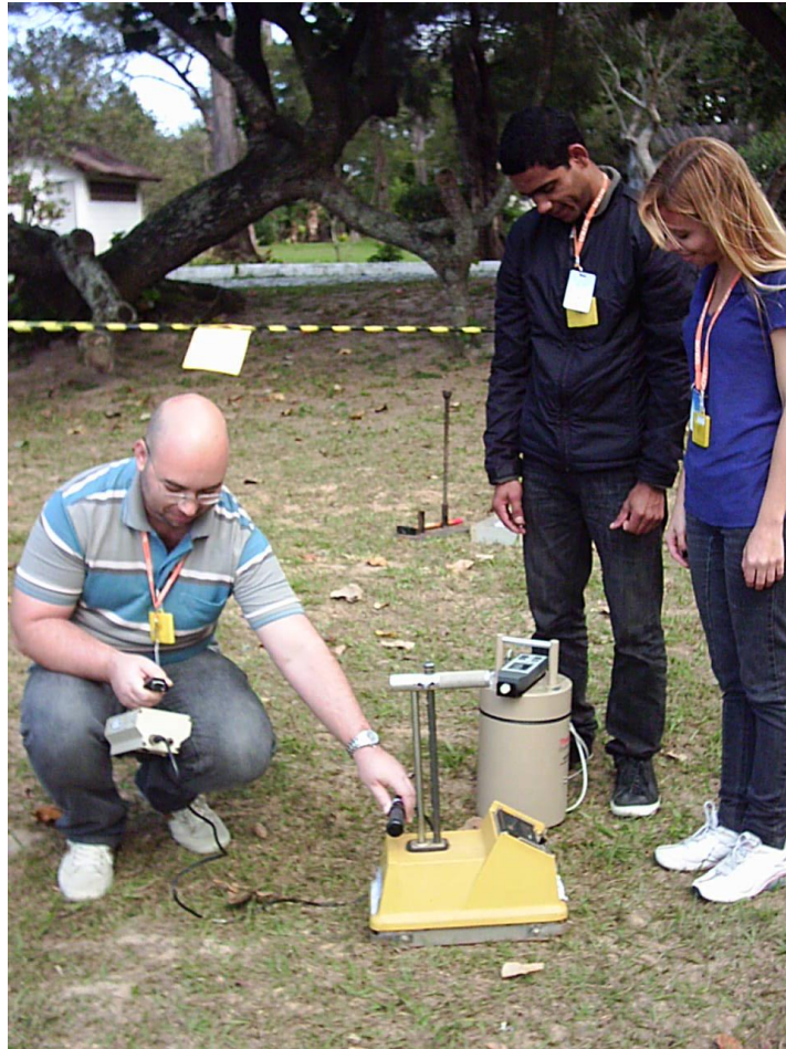
FIGURA 39 – Medida de confirmação do recolhimento da fonte.
