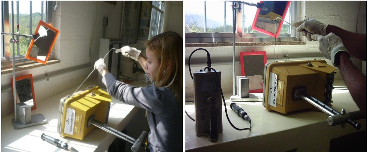
FIGURA 23 – Processo de esfregaço com constante monitoração da área.
