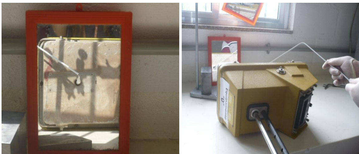
FIGURA 22 – Abertura da blindagem e introdução do amostrador no canal da fonte.
