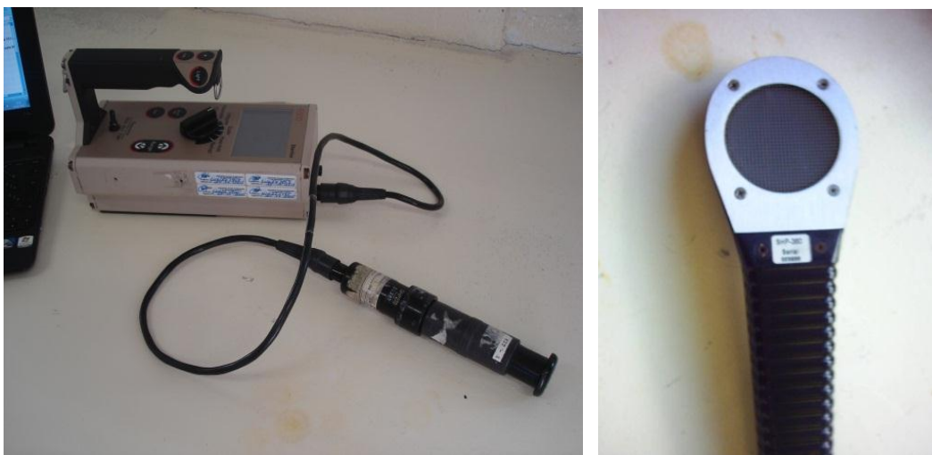
FIGURA 17 – Monitor com detector gama e detalhe do detector beta.
