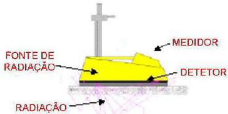
FIGURA 3 – Esquema de medição por retroespalhamento. (Fonte: www.lucianosantarita.pro.br , 2012)
