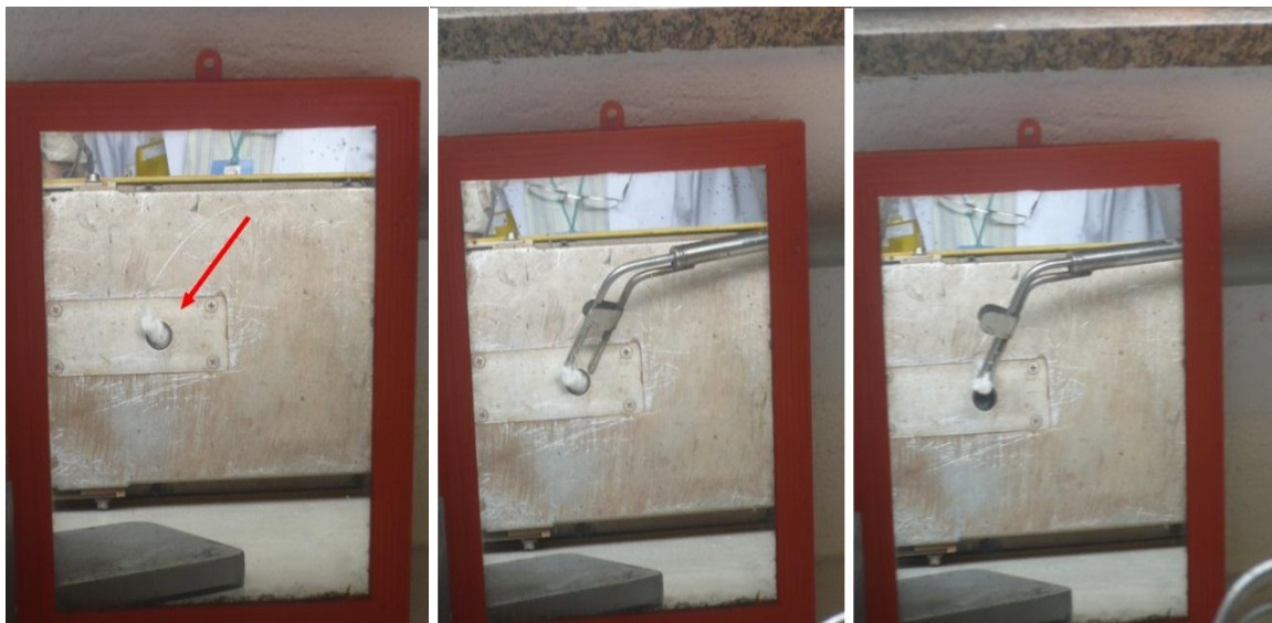
FIGURA 26 – Retirada da amostra presa no canal da fonte.
