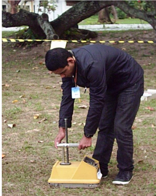
FIGURA 36 – Sonda introduzida no solo para posição de transmissão direta.
