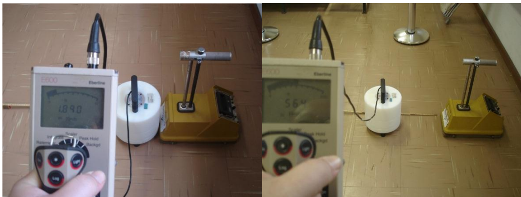
FIGURA 16 – Levantamento radiométrico para nêutrons na superfície e a 30 cm respectivamente.
