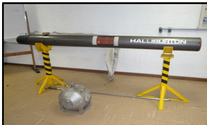
Figura 6 – Sonda de medição para perfilagem.
