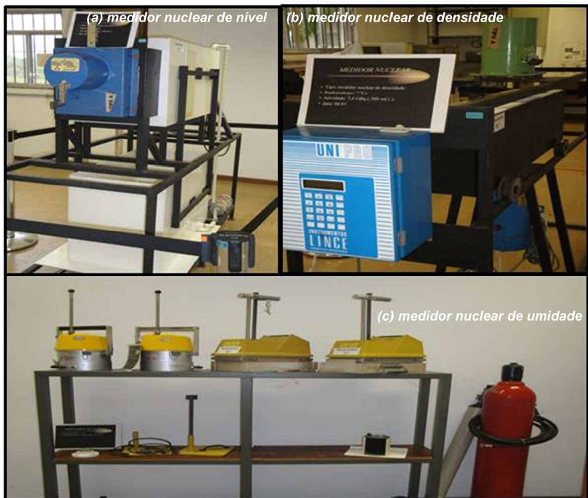
Figura 3 – Medidores nucleares do Laboratório do IRD: (a) medidor nuclear de nível; (b) medidor nuclear de densidade; e (c) medidor nuclear de umidade.
