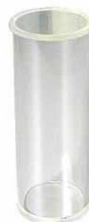
Figura 13. Dispositivo para teste de alinhamento do feixe
