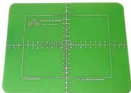
Figura 12. Dispositivo para teste de tamanho de campo
