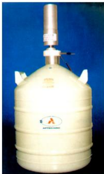
Figura 5: Detector de Germânio Hiperpuro (TAUHATA, 2006)
