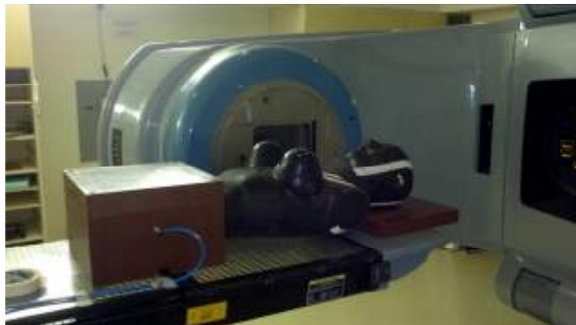
**Figura 18:** Arranjo experimental para medidas com câmara de ionização. No presente caso para o tratamento de cabeça e pescoço sem proteção de chumbo para a região do abdômen da paciente.
