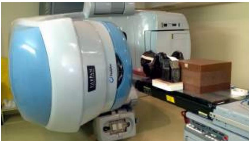
**Figura 15:** Arranjo experimental do tratamento de cabeça e pescoço do simulador Alderson feminino mostrando a blindagem de chumbo utilizada para proteger o útero da paciente.
