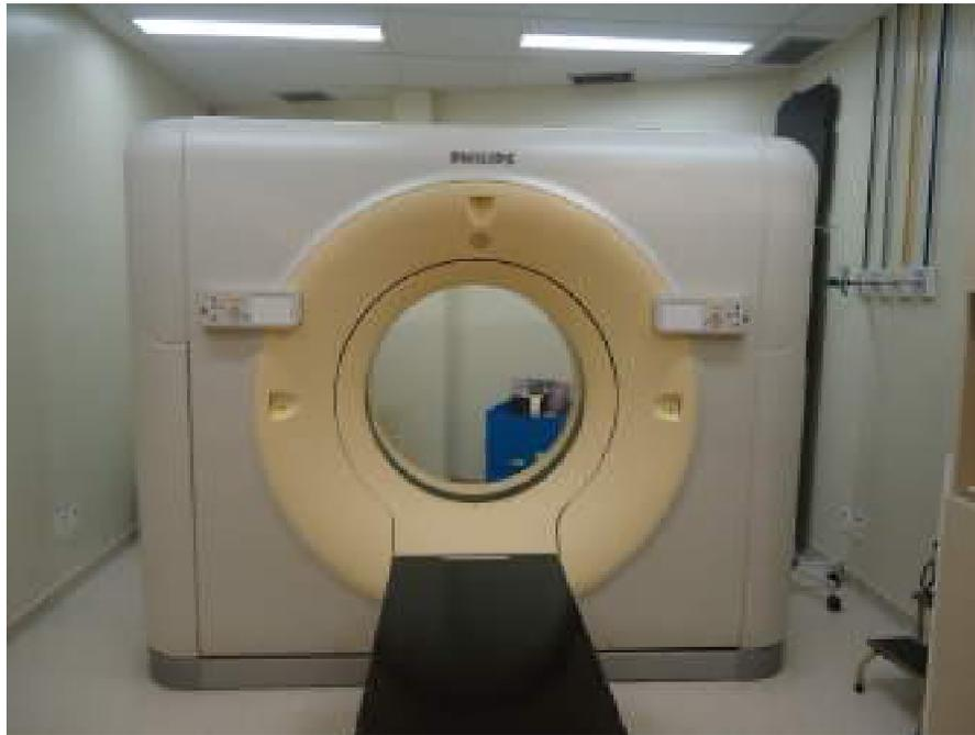
**Figura 11:** Tomógrafo Philips modelo Brilliance Big Bore, instalado no INCa, utilizado para a obtenção das imagens tomográficas usadas nos planejamentos de radioterapia.
