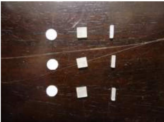
**Figura 3:** Exemplos de formatos de Dosímetros Termoluminescentes.
