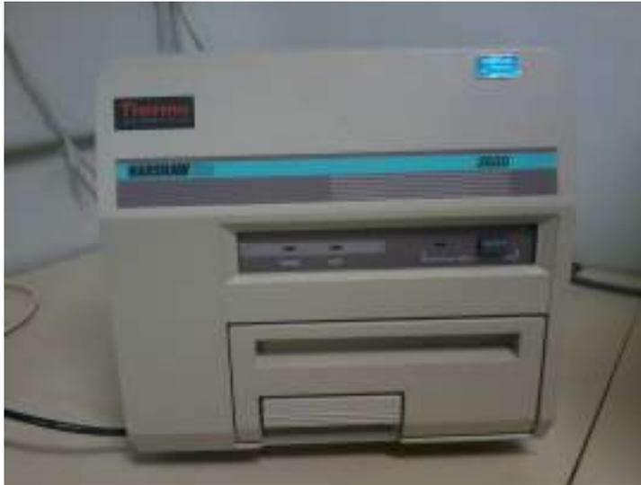
**Figura 6:** Leitora de TLD Harshaw 3500.
