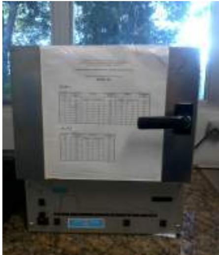
**Figura 5:** Forno PTW modelo TLDO utilizado para tratamento térmico dos dosímetros TL.
