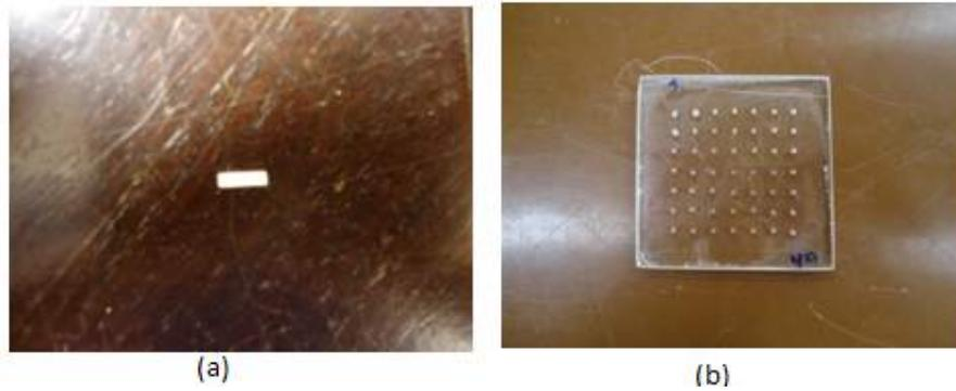
**Figura 4:** Fotos ilustrativas (a) do tipo de dosímetro TL utilizado no trabalho e (b) da placa de acrílico na qual foram feitas as irradiações para calibração desses dosímetros.
