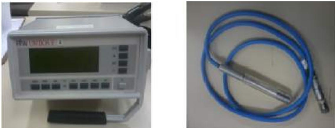
**Figura 7:** Foto ilustrativa do conjunto de câmara de ionização PTW 04702 TN 30013 (direita) e eletrômetro PTW UNIDOS 00665 (esquerda) utilizado neste trabalho.
