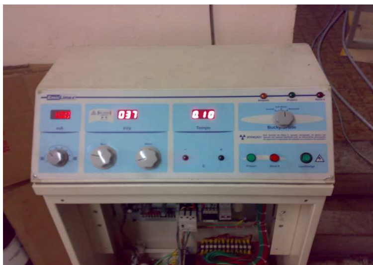
Figura 5 - Mesa de comando típica de um equipamento de raios X.
