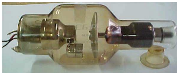
Figura 6 - Tubo de raios X de ânodo giratório. Fonte: Fiocruz
