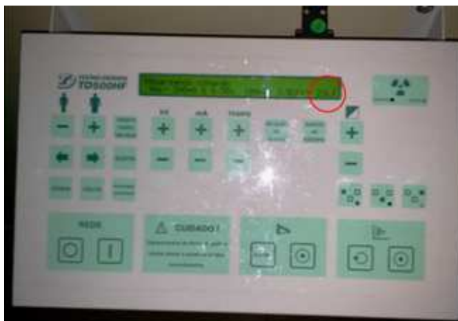
Figura 16 - Comando do equipamento de retificação de alta-freqüência utilizado neste trabalho com destaque para as unidades de calor
