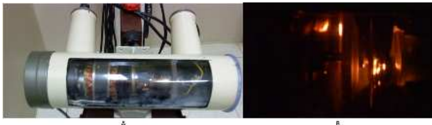
Figura 3 - a) Cúpula de raios X com abertura em acrílico para permitir visualização interna da estrutura; b) Filamento carregado pelo efeito termiônico.
