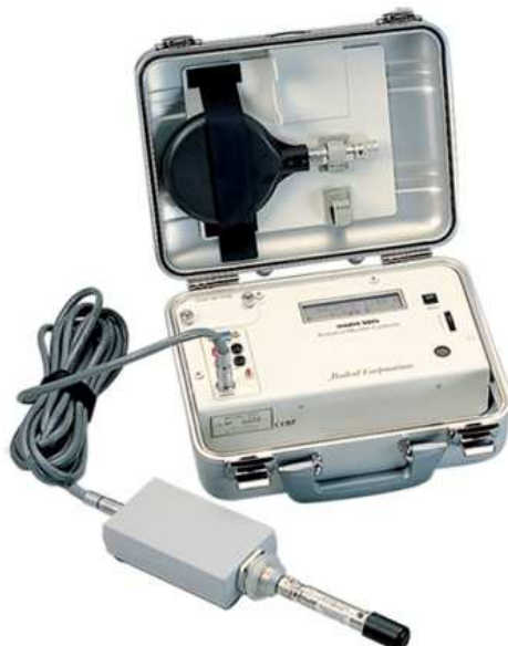
Figura 12 - Conjunto dosimétrico Radcal 9015 com eletrômetro à pilha na maleta e câmara de ionização tipo dedal.
