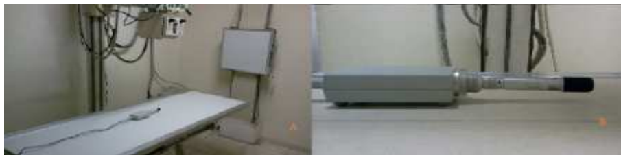
Figura 20 - a) Arranjo com a câmara de ionização próxima 3 cm do meio espalhador; b) destaque da distância câmara-mesa.
