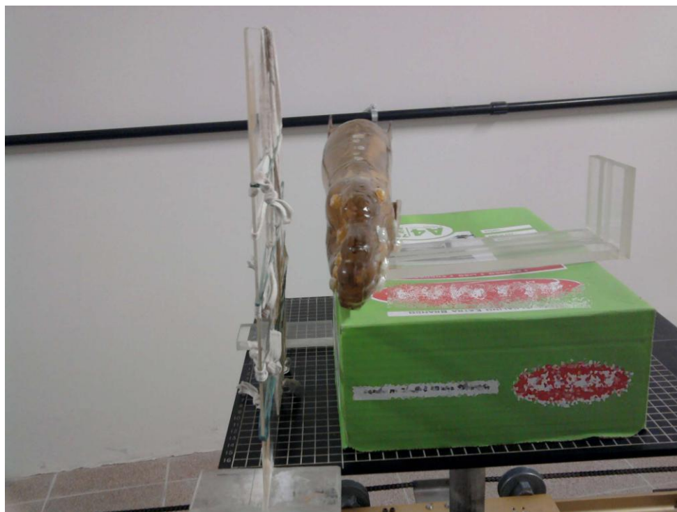
Figura 3. 15. Arranjo com placa de acrílico (PMMA) inserida à frente do fantoma para garantia do equilíbrio eletrônico.
