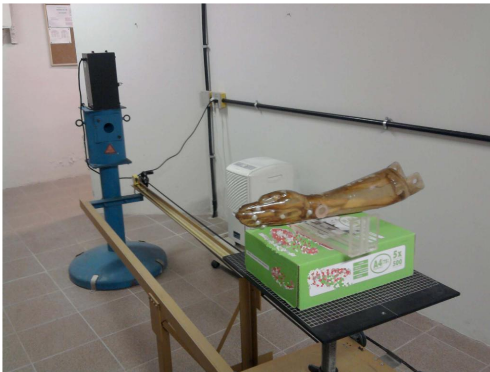
Figura 3. 14. Fantoma posicionado para irradiação com feixe de ^{137}\text{Cs} .
