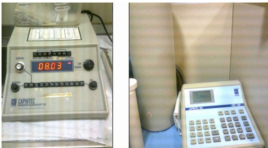
**Figura 3.9- Calibradores Capintec CRC-127R e CRC-25R**
