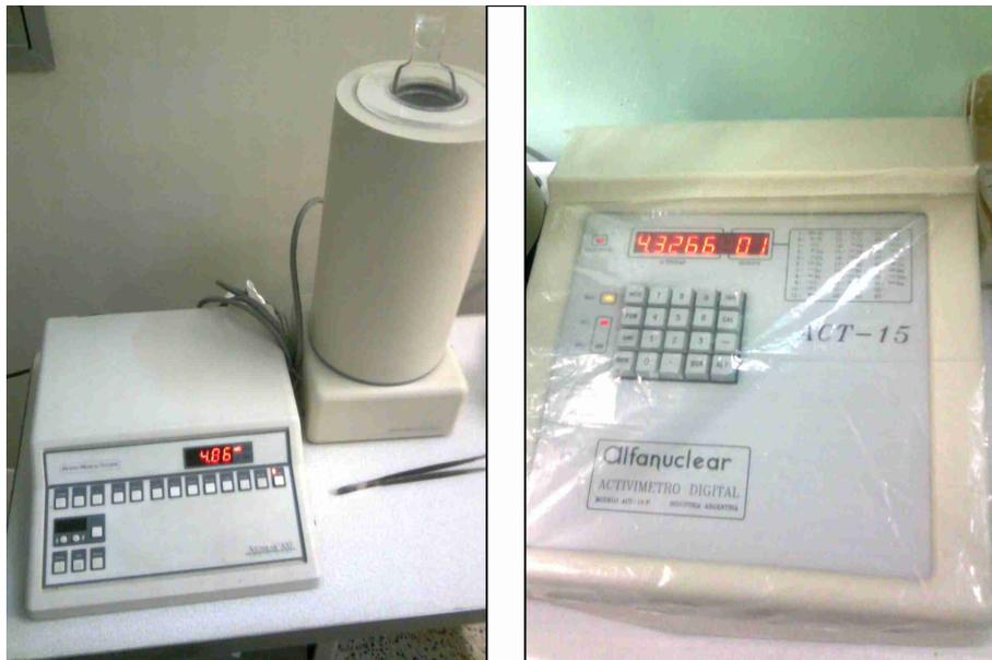
**Figura 3.10 - Calibradores Atomlab 100 e Alfanuclear ACT-15**
